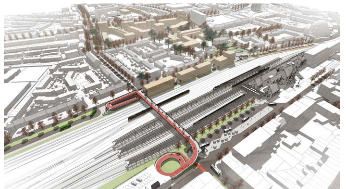
Naast een aantrekkelijke stationspassage voor voetgangers ter hoogte van de historische stationshal is een goede fietsverbinding van groot belang. Een optie die onderzocht wordt is een fietsbrug in het verlengde van de St. Maartenslaan. - Verdiepingsonderzoek OV-knoop Maastricht, 2020
